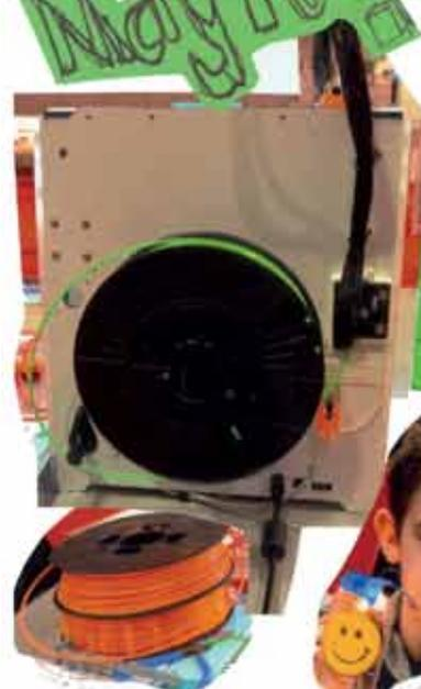
① Am der Rückseite des 3D-Druckers befindet sich eine Rolle mit Plastik drinnen.
